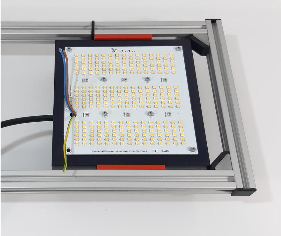
5. Dann kürzt man die Adern soweit ein (grüngelb um ca. 4cm, Braun und blau um ca. 5cm), so dass Sie in einem kleinen Bogen angeschlossen werden können. Dazu entfernt man die Isolierung um 8mm.
