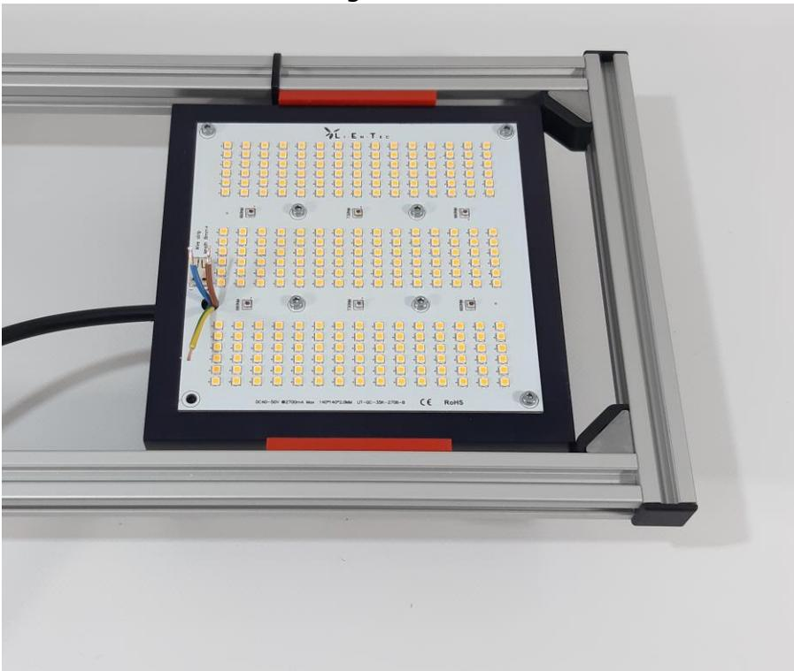
6. Einzelader ca. 1-2mm in die Anschlussklemme des Boards schieben, mit Hilfe eines kleinen Schraubendrehers die Plastikabdeckung des Anschluss terminals leicht hinunter drücken und das Kabel bis zum Anschlag schieben. Es darf kein blankes Kupfer mehr zu sehen sein! Falls notwendig, den Kabelschuh mit Hilfe einer Kabelschuhquetsche oder Zange an der Erdungs-Ader (Grün-Gelb) befestigen.
