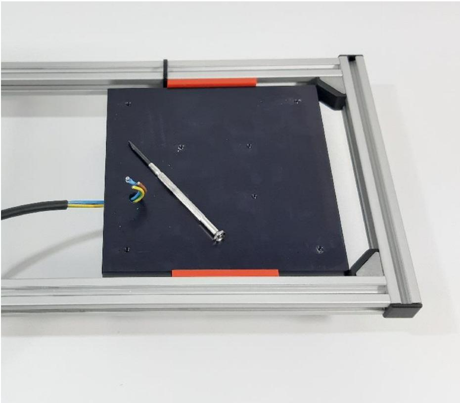
4. Montieren Sie nun die LED-Platine und schieben Sie das Kabel bis zum Anschlag, bzw. die Einzelader so weit, dass sie bis zu den Anschlussklemmen reicht.
